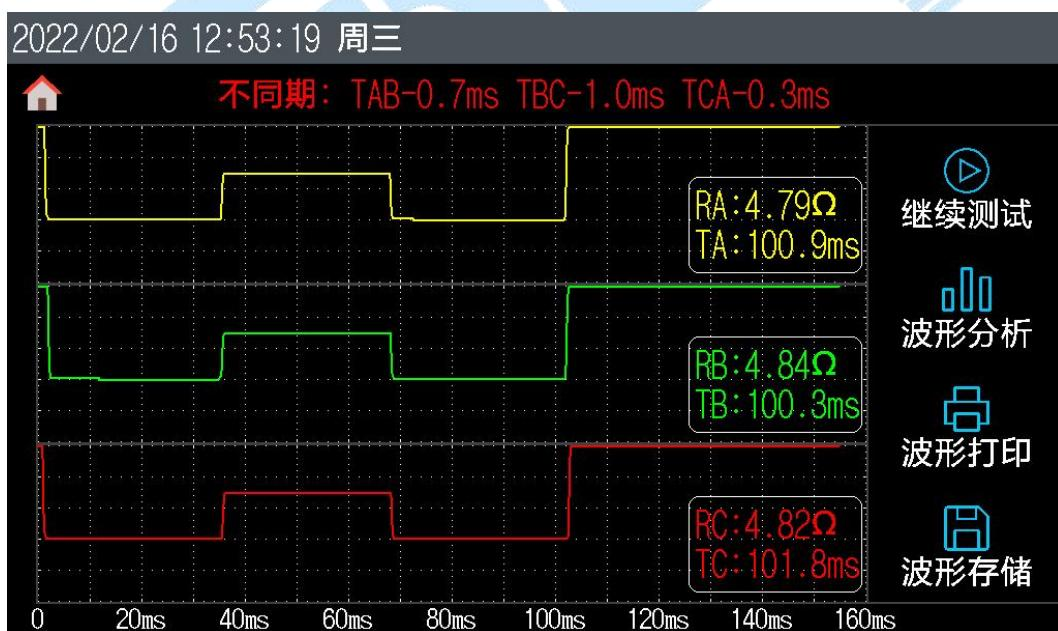
波形从上到下三个区域分别显示的是 A、B、C 三相的动作波形，在每条波形曲线下面有一条水平直线是零电流线，当切换过程中有断点时，曲线将与零电流线重合。仪器自动计算出三相波形的过渡电阻、过渡时间和三相不同期性，此部分仅供参考，对于自动测量有异议时可使用“波形分析”手动分析波形数
