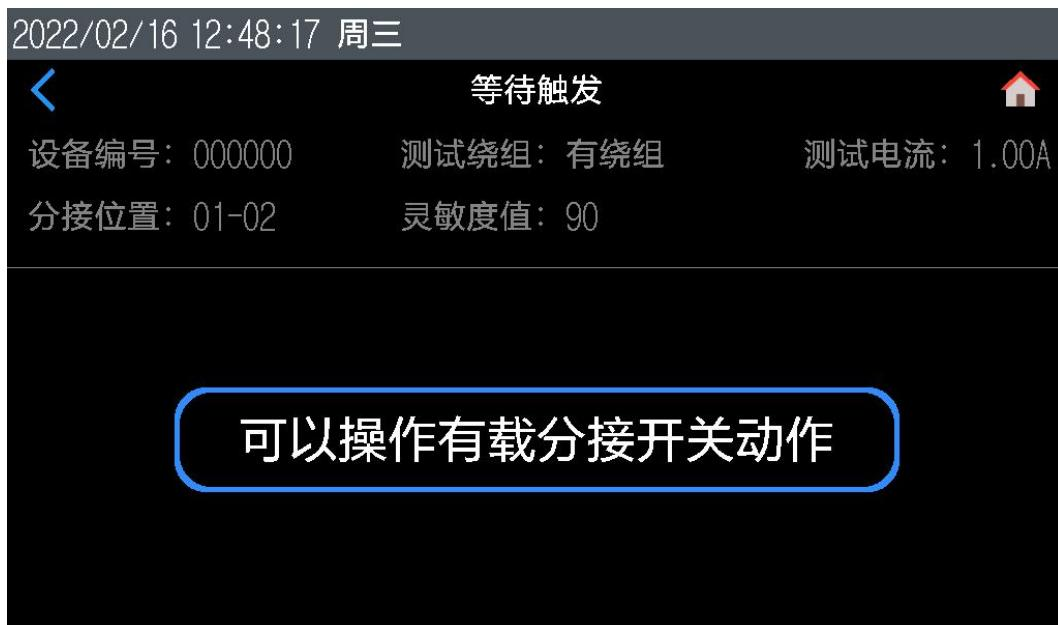
此时可手动或电动操作有载分接开关，有载分接开关动作完毕后，仪器自动进入“波形预览”界面。
