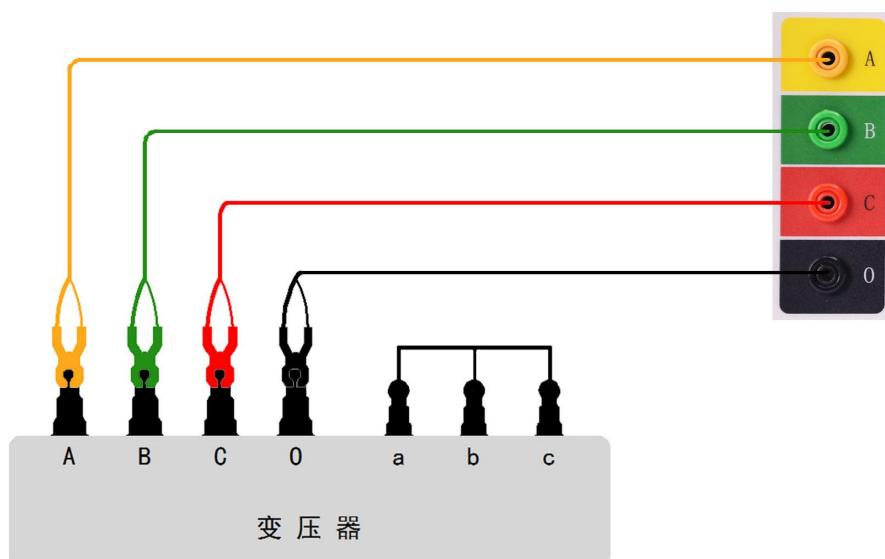
拆去被测变压器的所有引线，将非测试端（通常为中压侧、低压侧）分别
